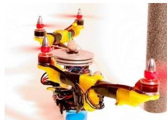
Le Quad-Morphing (Drone à ailes repliables en vol)
